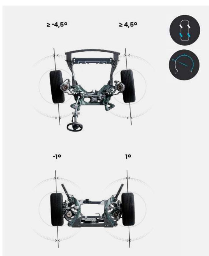
au-dessus de 50 km/h, les roues arrière tournent dans le même sens que les roues avant pour renforcer la tenue de route et améliorer la sécurité
